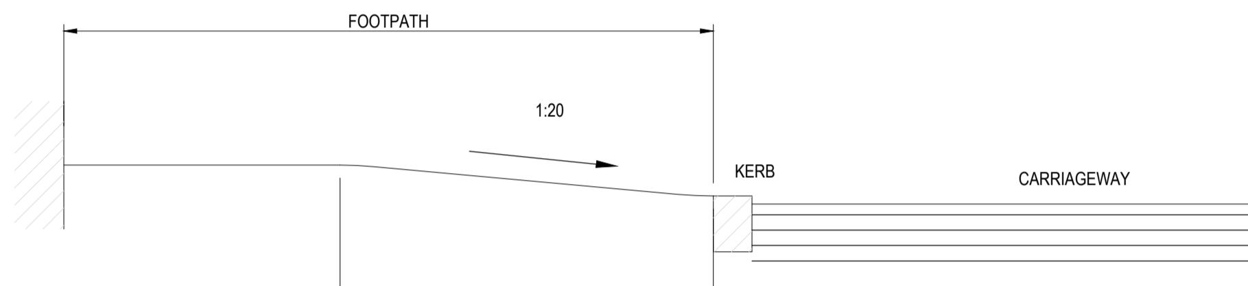
VARIABLE WIDTH. SHOULD NOT BE LESS THAN THAT REQUIRED TO ACHIEVE A GRADIENT OF 1:12 MAXIMUM
